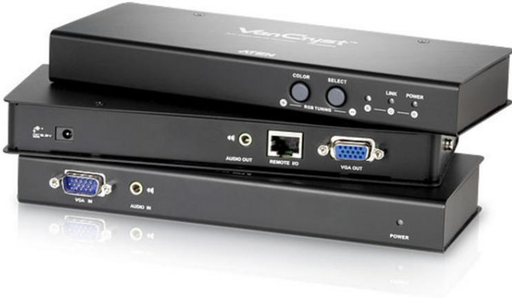
VE300 A/V Over Cat 5 연장기 시스템은 ATEN [VM0808T](#) Cat 5 A/V 매트릭스 스위치 설비에 원활하게 통합할 수 있도록 설계되었습니다. VE300은 최대 1600x1200의 해상도 (VE300R)를 150m까지, 또는 1280x1024의 해상도(VE300RQ)를300m 까지 A/V 소스와 디스플레이 모니터 사이의 거리를 확장할 수 있습니다.
