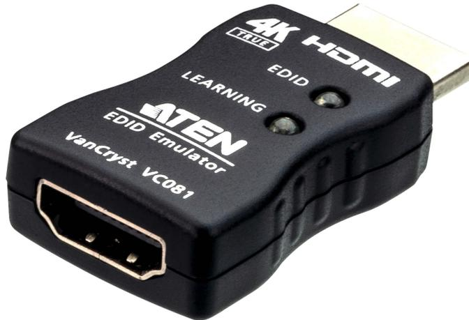
VC081 4K HDMI EDID 에뮬레이터는 AV 또는 KVM 연장기, 스위치 및 분배기와 함께 사용할 때 발생할 수 있는 EDID 관련 문제를 해결하도록 설계되었습니다. VC081은 HDMI 디스플레이의 EDID 정보를 읽어내 비디오 소스에 전달함으로써, HDMI 비디오 소스와 디스플레이 사이의 EDID 데이터가 올바르게 동기화되지 않을 때 발생하는 비디오 통신 문제를 효과적으로 해결할 수 있습니다. 또한 디스플레이의 EDID 정보를 읽어낸 후, PC에 모니터 대신 VC081을 연결하여 IP를 통한 원격 접속 제어 시 해당 PC 또는 서버를 절전 모드로 유지할 수 있습니다.
