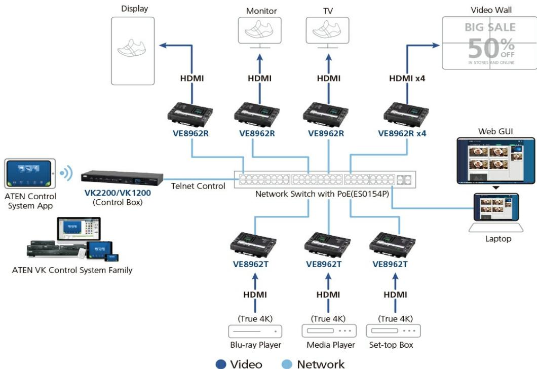
안내: PoE 지원으로 PoE 네트워크 스위치와 연결 시 전원 케이블 및 추가 콘센트 최소화 가능합니다. 위치 선택 및 설치 전, 구현 가이드를 참조하시길 바랍니다.
