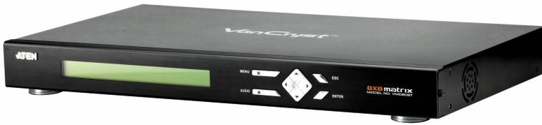
VanCryst™ 미디어 매트릭스 솔루션은 VM0808T 8x8 Cat 5 A/V 매트릭스 스위치와 VE500 / [VE300](#) A/V Over Cat 5 연장기의 조합입니다. VM0808T은 최대 300m 먼 거리에서 오디오, 비디오, RS-232 신호를 비디오 해상도 1280x1024로 전송하고 분배하는 매트릭스 스위치입니다.
