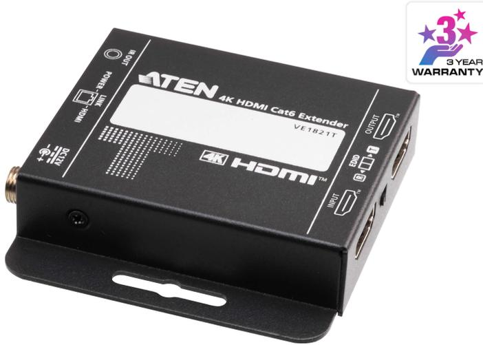
완벽한 엔드투엔드(end-to-end) 솔루션인 VE1821은 송신기와 수신기로 구성되었으며 ATEN Cat 6 케이블\*을 통해 HDMI 신호를 최대 4096 x 2160 / 3840 x 2160 @ 30Hz(4:4:4)로 최대 40m까지 연장합니다. 대기 시간 없이 4K 소스를 전송하는 기능으로 선명한 비디오 프레젠테이션이 보장되며 LPCM 7.1CH, Dolby TrueHD, Dolby Digital Plus, DTS-HD Master Audio 등 무손실 오디오 포맷 지원으로 영상 콘텐츠에 우수한 사운드를 추가해 시청 경험을 향상 시킵니다.
