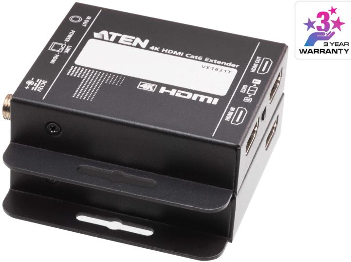
완벽한 엔드투엔드 end-to-end 솔루션인 VE1821은 송신기와 수신기로 구성되었으며 ATEN Cat 6 케이블\*을 통해 HDMI 신호를 최대 4096 x 2160 / 3840 x 2160 @ 30Hz(4:4:4)로 최대 40m까지 연장합니다. 대기 시간 없이 4K 소스를 전송하는 기능으로 선명한 비디오 프레젠테이션이 보장되며 LPCM 7.1CH, Dolby TrueHD, Dolby Digital Plus, DTS-HD Master Audio 등 무손실 오디오 포맷 지원으로 영상 콘텐츠에 우수한 사운드를 추가해 시청 경험을 향상 시킵니다.
