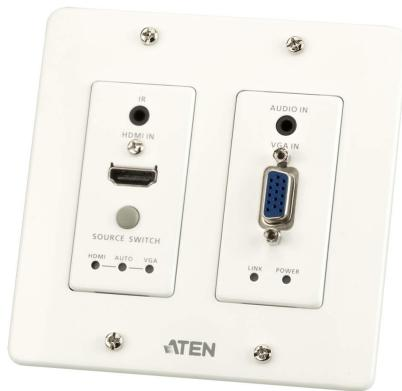
ATEN VE2812UST 는 Cat 5e / 6 / 6a 또는 ATEN [2L-2910](#) Cat 6 케이블을 통해 VGA (오디오 포함) 및 HDMI 신호를 최대 100m 전송하기 위한 송신기입니다. US 월 플레이트 설계로 VE2812UST 는 2-Gang 접합 박스에 편리하게 장착될 수 있습니다. VE2812UST 는 HDMI / VGA 신호의 안정적인 전송을 보장합니다. HDMI 신호 전송의 경우 3D, Deep Color 및 내장 HD 무손실 오디오 형식을 지원합니다. 장거리 전송을 위해 롱 리치 모드를 지원하여 1080p 의 해상도에서 단일 Cat 5e / 6 케이블을 통해 최대 150m 를 연장합니다.
