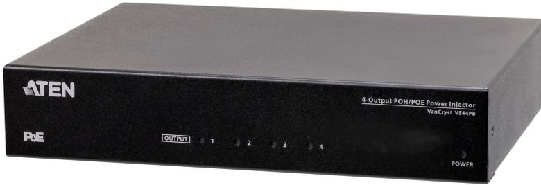
VE44PB는 cat 5e / 6 / 6a 케이블을 이용해 최대 4개의 호환 가능한 PoH, PoE 전원 장치를 통해 원격으로 전원을 공급해주는 4포트 전원 공급 장치 (파워 인젝터)입니다. Pro AV 장비에 VE44PB를 설치하면 연결된 장치의 로컬 전원 공급 장치가 필요 없으며, PSE 포트 당 최대 15.4W의 전력을 공급합니다. HDBaseT 연결 기능을 갖춘 VE44PB는 Cat 6 / 6a 케이블을 통해 장거리로 HDMI 연결을 확장 할 수 있으며 이에 영향을 받지 않는 비디오 및 이미지 품질을 보장합니다. 또한 전면 패널의 상태 LED는 연결된 장치의 개요를 한눈에 보여 주며, 긴급한 상황시 실시간 모니터링 및 문제 해결을 할 수 있게 해줍니다. 소형 랙에 장착이 가능한 디자인으로 원격 PoH/PoE 전원이 필요한 송신기와 수신기 사이 어디든 유연하게 설치할 수 있습니다.
