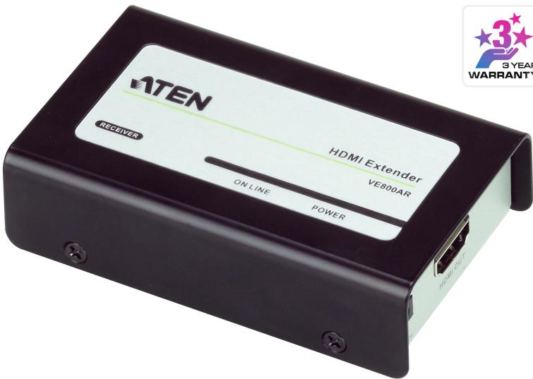
HDMI 수신기 VE800AR은 HDMI 디스플레이를 하나의 Cat 5e 케이블을 이용하여 HDMI 소스를 최대 60m까지 디스플레이 할 수 있도록 연장합니다. ATEN의 [VE800A](#)는 신기술을 적용하여, A/V 신호를 하나의 Cat 5e 케이블을 통해 전송할 수 있습니다. DDC 포트는 또 다른 Cat 5e 케이블로 간편히 연결만 하여 디스플레이의 EDID를 활용할 수 있도록 도와줍니다. [VE800A](#)는 3D와 Deep Color와 같은 HDMI 기능을 지원하여 최상의 품질을 제공합니다.
