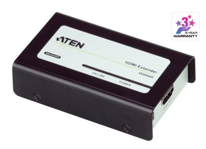
HDMI 수신기 VE800AR은 HDMI 디스플레이를 하나의 Cat 5e 케이블을 이용하여 HDMI 소스를 최대 60m까지 디스플레이 할 수 있도록 연장합니다. ATEN의 <u>VE800A</u>는 신기술을 적용하여, A/V 신호를 하나의 Cat 5e 케이블을 통해 전송할 수 있습니다. DDC 포트는 또 다른 Cat 5e 케이블로 간편히 연 결만 하여 디스플레이의 EDID를 활용할 수 있도록 도와줍니다. <u>VE800A</u>는 3D와 Deep Color와 같은 HDMI 기능을 지원하여 최상의 품질을 제공합니다.
