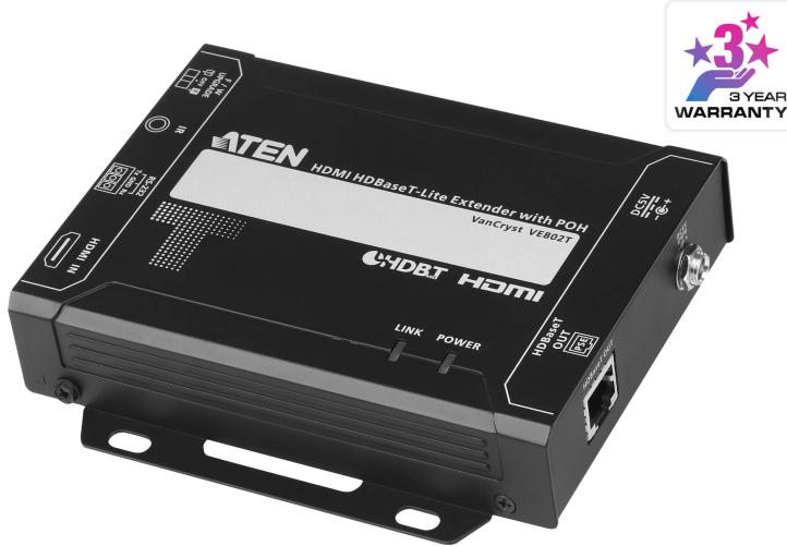
VE802T는 HDBaseT 수신기\*와 연결하면 하나의 Cat 5e/6/6a 케이블을 통해 소스로부터 최대 70m까지 신호를 연장할 수 있습니다. RS-232 및 IR 시그널링 패스스루를 지원하여 원격 장치( [VE802R](#))에서 HDMI 소스 장치를 제어하는 동시에 로컬 장치(VE802T)에서 HDMI 디스플레이 장치에 대한 접속을 허용합니다. 또한 IR 신호는 양방향으로 확장될 수도 있습니다. VE802T는 PoH(Power over HDBaseT) 기능을 갖추고 있어 추가 전원 공급 장치 없이 Cat 5e/6/6a 케이블을 통해 전원을 보낼 수 있습니다. HDMI(3D, Deep Color,4k) 및 HDCP의 호환되는 VE802T는 디지털 엔터테인먼트 센터 또는 우수한 비디오 품질이 필요한 모든 환경에 적합합니다.
