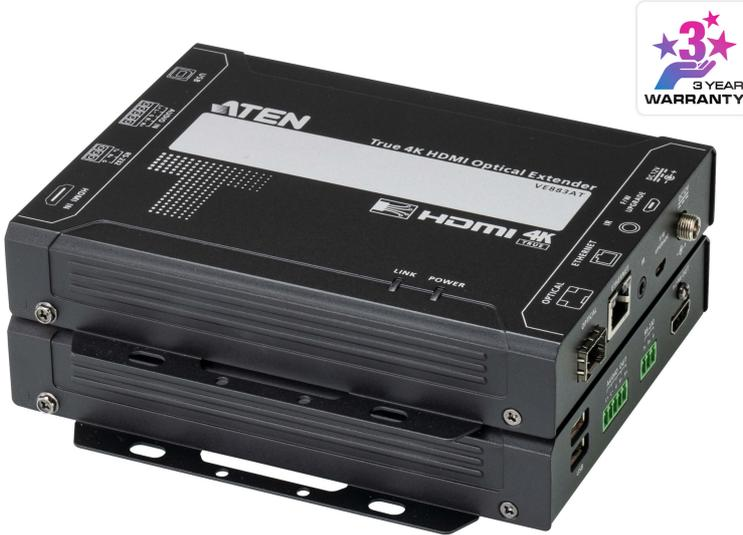
VE883A는 송신기 VE883AT와 수신기 VE883AR로 구성된 True 4K HDMI 광 연장기로, 단일 이중 광 섬유 케이블을 통해 최대 4096 x 2160 / 3840 x 2160 @ 60Hz (4:4:4) HDMI, 오디오, USB 2.0, IR, RS-232, 기가비트 이더넷 신호를 300m (VE883AK1) 또는 10km (VE883AK2)에 무손실로 전송합니다. VE883A는 광 섬유 케이블로 전기적으로 절연되어 있어 RF 및 EMI에 영향을 받지 않으며 부피가 큰 케이블 설치가 필요하지 않습니다. ATEN의 독점적인 FarSmooth 기술 사용으로 출력 속도를 입력 속도와 일치시켜 지연 및 정지를 방지하고, 특히 중단 없는 비디오 스트림이 필요한 장거리 확장 애플리케이션에서 비디오 디스플레이가 안정적이고 원활하며 소스와 동일하도록 보장합니다.
