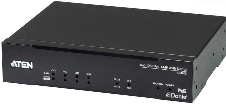
AD400E는 4채널 밸런스/언밸런스 마이크라인 레벨 오디오 신호를 단테 패킷으로 변환하여 단테 호환 장비에 전송할 수 있습니다. AES67을 준수하여 서로 다른 오디오 네트워크 프로토콜과 장치 간 상호 운용성을 높일 수 있으며 24비트 및 44.1k, 48k, 88.2k, 96kHz의 샘플링 속도 옵션을 지원하여 다양한 상업용 애플리케이션에 대응할 수 있습니다. 전문적인 프리앰프 회로가 내장된 AD400E는 넓은 다이내믹 레인지, 높은 신호 헤드룸, 훌륭한 신호 대 잡음비(SNR)를 제공할 수 있으며 모든 개별 입력 포트에 콘덴서 마이크 지원을 위한 +48V 팬텀 파워가 내장되어 있습니다.
