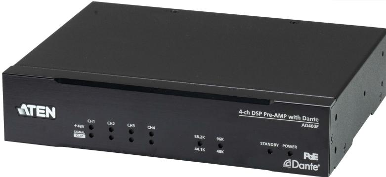
AD400E는 4채널 베이스/언밸런스 마이크/라인 레벨 오디오 신호를 Dante 패킷으로 변환하여 단체 회로에 전송할 수 있습니다. AES67을 준수하여 서로 다른 오디오 네트워킹 프로토콜과 장치 간 상호 운용성을 높일 수 있으며 24비트 및 44.1kHz, 48kHz, 88.2kHz, 96kHz의 샘플링 속도 옵션을 지원하여 다양한 상업용 애플리케이션에 대응할 수 있습니다. 전문적인 프리앰프 회로가 내장된 AD400E는 낮은 다이나믹 레인지, 높은 신호 헤드룸, 출중한 신호 대 잡음비(SNR)를 제공할 수 있으며 모든 개별 입력 포트에 존에서 마이크 지원을 위한 +48V 펜텀 파워가 내장되어 있습니다.
