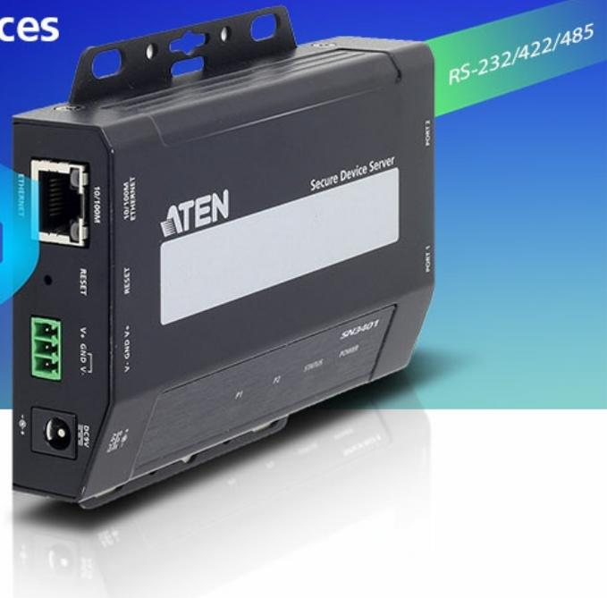
SN3401은 사용이 간편하고 안전하며 안정적인 솔루션으로 다양한 시리얼 장치를 IP 기반 이더넷 LAN에 즉시 연결할 수 있습니다. SN3401은 간단하고 빠른 시리얼-이더넷 연결을 제공하여 원격으로 PC에서 시리얼 RS-232/422/485 장치에 접근할 수 있게 합니다. 안정적인 기능을 다양하게 갖춘 SN3401은 상업 및 산업 공정 제어 애플리케이션에 이상적입니다.
