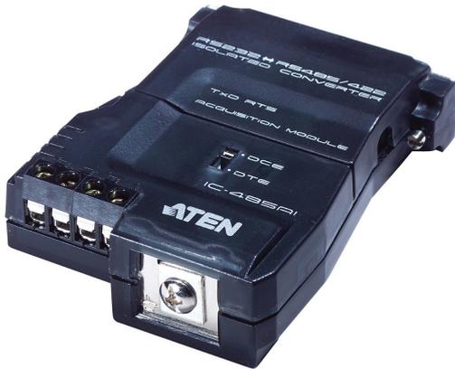
IC485AI는 최대 1,200m (4,000 피트)까지의 장거리 애플리케이션에서 RS-232 신호를 RS-422 / RS-485 신호로 변환하는 양방향 컨버터입니다. 내장된 RS-485 자동 흐름 및 방향 모니터링 기능으로 신호 서지를 억제 할 수 있습니다.
