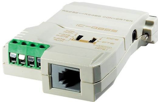
IC485S는 2가지 방식 컨버터로 RS-232신호와 장거리 어플리케이션(최대 1200미터(4000피트))에서 RS-422/RS-485신호를 변환 합니다. 최대 32개의 허브 연결을 지원합니다.
