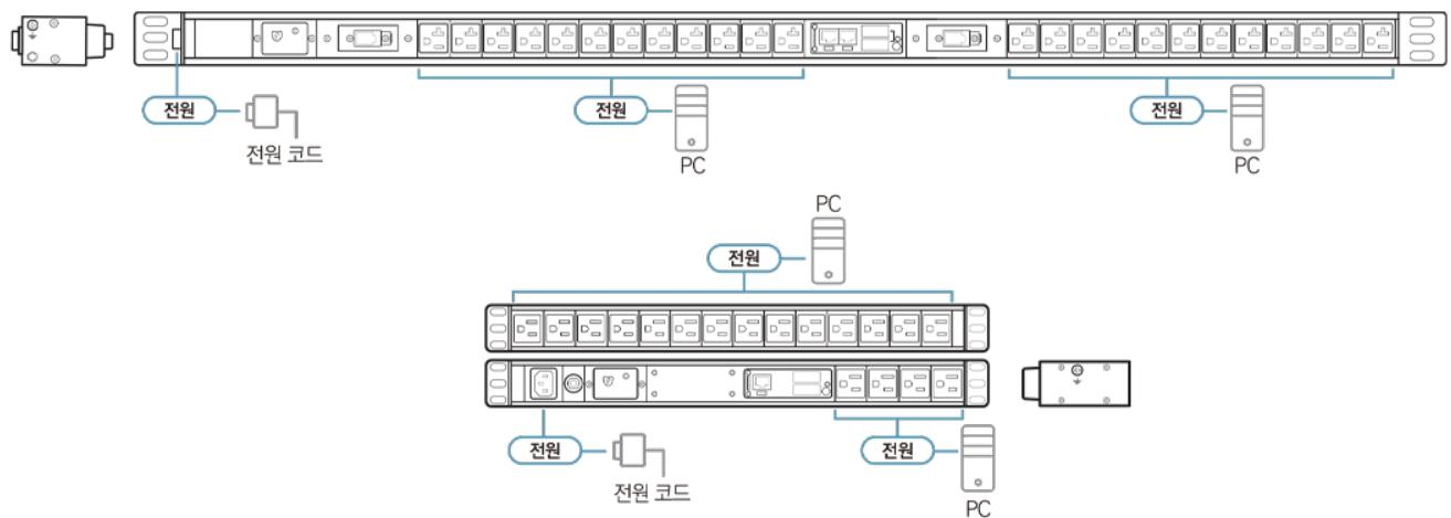
안내: Basic Metered PDU는 종류가 많기 때문에, 이 다이어그램에서는 각각 0U와 1U 예시로 PE1324S(상단)와 PE1118S(하단)을 사용했습니다.
