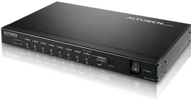
ALTUSEN PN0108은 편리한 서버 룸 관리를 위한 8개의 핫 플러그 포트가 구성되어 있습니다. 각각의 포트를 개별적으로 제어 할 수 있도록 하여, 사용자는 각 포트의 장비가 올바른 순서로 켜질 수 있도록 전원 on 순서 및 시간 지연 설정이 가능합니다. ON/Off 스케줄링은 매일, 매주, 매월 단위로 사전 설정으로 시작/재시작/리셋 할 수 있습니다. PN0108은 원격으로 서버룸에 액세스하기 위한 가장 편리하고, 신뢰할 수 있으며 비용 효율적인 방법입니다.
