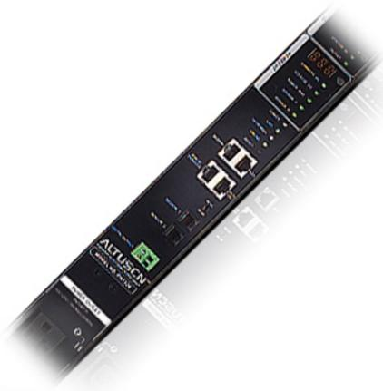
ALTUSEN PN7212 Power Over IP는 IT 관리자가 TCP/IP 연결을 통해 어떠한 장소에서 유닛에 연결된 장치의 전원을 아웃렛 레벨로 원격 제어하도록 하는 전원 관리 유닛입니다. PN7212는 전원 상태를 측정함으로써 관리자가 IT 장비 및 PDU의 전류, 전압, 및 전력 소모를 PDU 또는 아웃렛 레벨로 모니터링 하여 장비의 전력 소모 비용을 최소화하고, 모든 크기의 서버 룸에 높은 단계의 시스템 활용도를 보장하도록 합니다.
