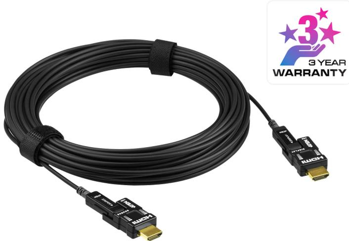
ATEN의 VE7833 광케이블은 입력 신호와 광학 신호 간 변환을 가능하게 하는 AOC 기술을 활용하여 최적의 고대역폭 데이터를 전송합니다. EMI 저항 광 케이블로 30m의 길이에 True 4K 해상도를 지원합니다. HDCP 2.2 표준과 완벽하게 호환되어 3D, Deep Color, 18Gbps의 데이터율을 포함한 HDMI 2.0 사양을 충족합니다. Dolby True HD 그리고 DTS-HD Master 오디오를 지원하며 무실점 오디오 신호 전송을 보장합니다.
