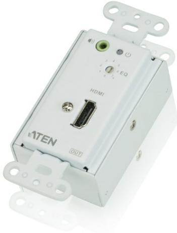
El Receptor de HDMI en placa de pared mediante Cat 5 VE806R se conecta a un [VE806T](#) para aumentar las señales hasta 60 metros desde la fuente, utilizando cables Cat 5e. Es compatible con los populares formatos de pantalla ancha y garantiza una excelente calidad de vídeo a través de las transmisiones de larga distancia. La combinación [VE806](#) puede aumentar aún más la distancia o multiplicar las fuentes/pantallas.
