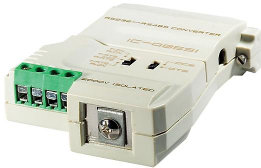
El IC485SI es un convertidor bidireccional con el que convertir señales RS-232 a RS-422/RS-485 en aplicaciones a larga distancia, de hasta 1200 m (4000 ft). Incluye una lengüeta de conexión a tierra para mejorar el aislamiento eléctrico y la señal.
