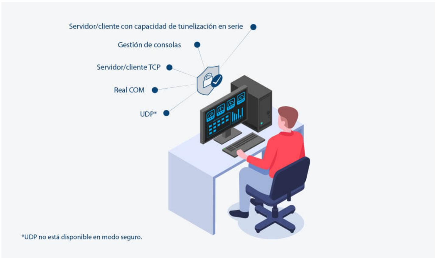
El servidor SN3001P ofrece una amplia selección de modos de funcionamiento para poder visualizar diferentes tipos de dispositivos serie en la red. Entre otros, admite los modos Real COM, TCP, tunelización en serie, gestión de consolas y UDP. Cada modo de funcionamiento del SN3001P está equipado con funciones seguras avanzadas que permiten a los usuarios agilizar las operaciones y garantizar la transmisión segura de los datos en serie.
