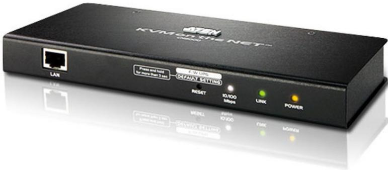
El CN8000 es una unidad de control que agrega capacidades "Sobre IP" a los switches KVM que no incluyen funciones IP en sus características. Esto permite a los operadores monitorear y acceder sus servidores desde una ubicación remota usando un Cliente Windows o Java basado en browser.
