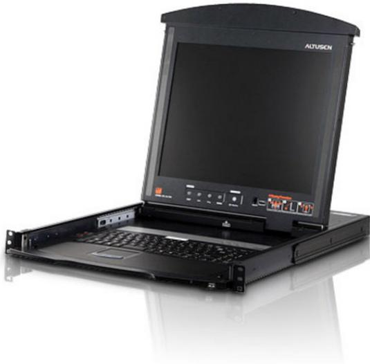
La KL1100 es una consola KVM con single display LCD de 17" o 19", un teclado completo y un panel táctil incorporados en una carcasa retráctil que se puede montar en un alojamiento 1U estándar en rack, disponible en modelos alimentados por corriente continua o alterna. Para agregar más conveniencia, proporciona puertos PS/2 para mouse o teclado externo y una conexión para monitor en la parte posterior, permitiendo manejar el Switch desde una consola local.
