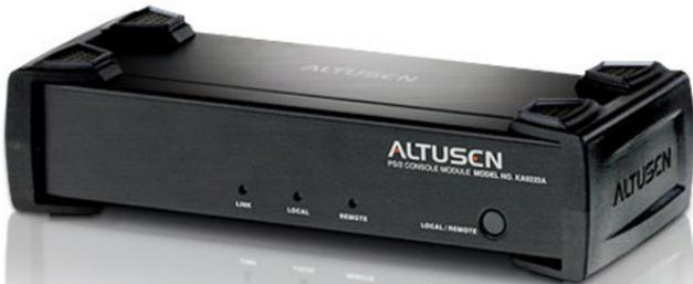
El Módulo de Consola KA9222A de ALTUSEN controla un computador local y un Switch KVM Matrix™ remoto.
