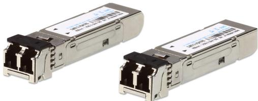
El módulo transceptor SFP a 1,25 G de fibra multimodo 2A-136G ofrece una conectividad de 1 GbE hasta 550 metros. El transceptor se puede instalar tanto en transmisores como en receptores. Al ser un módulo conectable en caliente con un conector dúplex estándar para las comunicaciones por fibra, el 2A-136G funciona con conexiones de fibra multimodo (MMF) y trabaja a una longitud de onda nominal de 850 nm. Esto lo convierte en un transceptor rentable y de alto rendimiento.
