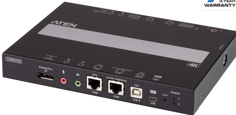
El RCMDP101U es un switch KVM con acceso por IP DisplayPort de un solo puerto diseñado exclusivamente para aplicaciones de línea de producción capaz de gestionar cómodamente el acceso a vídeo, audio, ratón y teclado, así como a los virtual media de una estación de trabajo en una línea de producción mediante consolas locales y remotas. También permite el uso de micrófonos y altavoces, tanto en las consolas locales como en las remotas.
