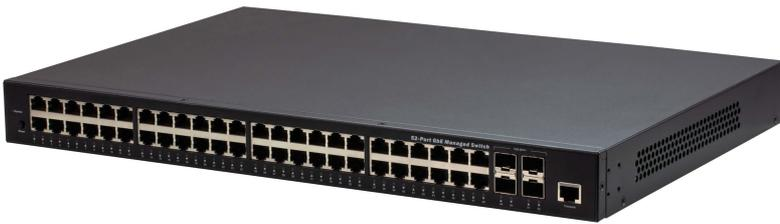
El ES0152 es un switch gestionado multifunción para los extensores KVM sobre IP de la serie ATEN KE y los extensores de video sobre IP de la serie VE89. Es perfecto para instalaciones cuando se combina con los productos de la serie KE / VE89, con el ES0152 los usuarios puede crear su infraestructura OT con la serie KE al eliminar los inconvenientes de una configuración complicada.
