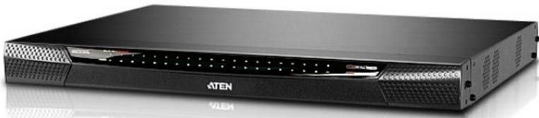
La nueva generación de switches KVM sobre IP de Aten, la serie KN, permite acceso a consola local y acceso remoto sobre IP para que los operadores supervisen el centro de datos y accedan a él a través de la red desde el navegador web. Además ofrecen acceso fuera de banda con compatibilidad con módem externo para la resolución de problemas a nivel de la BIOS cuando la red se encuentra inactiva.
