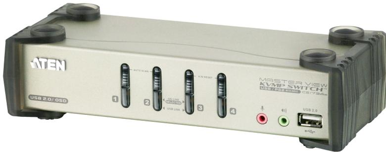
El CS1734B es un Switch KVM de 4 puertas combinado con un Hub USB 2.0 de 2 puertas. Como switch KVM, permite a los usuarios acceder a dos ordenadores desde un solo teclado, monitor y mouse. Hay cuatro posibilidades de obtener acceso instantáneo a cualquier computadora conectada: pulsadores, teclas de acceso directo, menú OSD y mouse.
