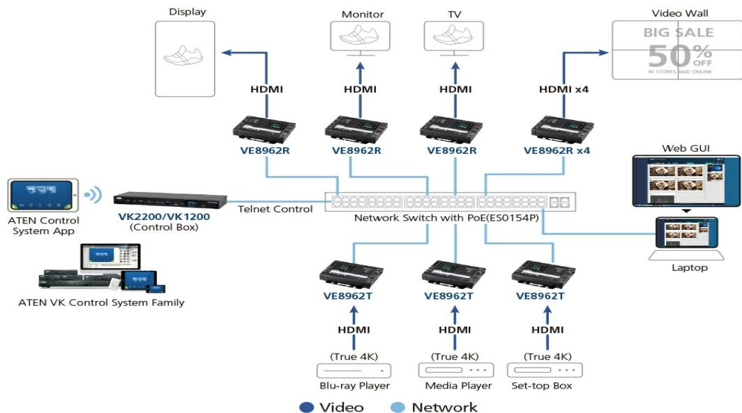
Nota: El VE8962 es compatible con PoE y se puede instalar en combinación con commutadores de red PoE para reducir el cableado eléctrico y las tomas de corriente adicionales. Antes de elegir el commutador de red y la instalación, consulte la Guía de implementación.
