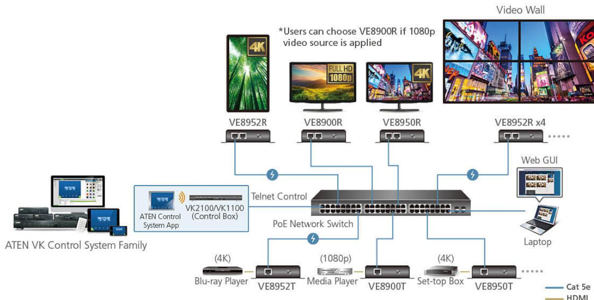
\*Nota: VE8952 admite PoE y se puede instalar en combinación con switches PoE para reducir los cables de alimentación y las tomas de corriente adicionales. Antes de elegir el switch de red y la instalación, consulte la Guía de implementación.
