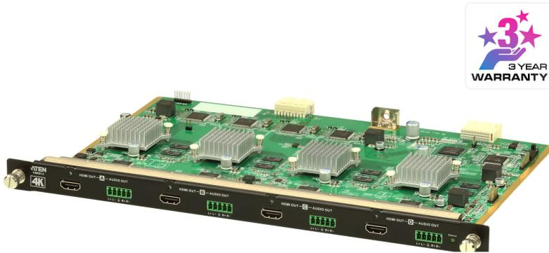
La VM8814 es una tarjeta de salida HDMI 4K que se combina con un switch de matriz modular de ATEN para facilitar el enrutamiento de 4 fuentes HDMI hasta 4 pantallas. Además de la interfaz HDMI para señales de audio/vídeo digitales, la VM8814 tiene 4 puertos de salida de audio estéreo que permiten la extracción de audio HDMI.
