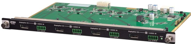
La VM7904 es una tarjeta de entrada DisplayPort 4K que se combina con un switch de matriz modular de ATEN para facilitar el enrutamiento de 4 fuentes de audio y vídeo DisplayPort a un máximo de 16 o 32 pantallas. Además de la interfaz DisplayPort para señales de audio/vídeo digital, la VM7904 tiene también 4 puertos de entrada de audio estéreo que permiten el enrutamiento independiente o la incrustación de audio estéreo para la salida HDMI.
