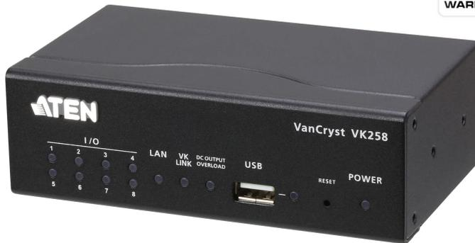
O VK258 fornece conectividade Ethernet para E/S digital com 8 canais de entrada/saída digital. Permite aos utilizadores aceder remotamente a dispositivos de entrada/saída digital a partir de um PC ou de qualquer sistema localizado em qualquer lugar. Os comandos Telnet CLI completos estão totalmente integrados nas aplicações comerciais e industriais dos utilizadores.
