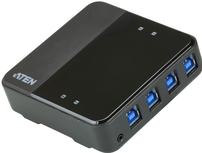
El ATEN US434 es un dispositivo para compartir periféricos con 4 puertos USB 3.2 Gen1 que permite a los usuarios compartir cuatro dispositivos USB entre 4 ordenadores distintos. El US434 es compatible con la tecnología USB 3.2 Gen1, capaz de alcanzar velocidades de datos de hasta 5 Gbps, y es compatible de forma regresiva con dispositivos USB 2.0 y USB 1.1. Es perfecto para dispositivos con un ancho de banda elevado, como las bases USB y las cámaras de alta definición.
