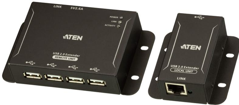
El extensor USB 2.0 Cat 5 de 4 puertos UCE3250 es un dispositivo de dos unidades que realiza las funciones de switch USB y extensor USB. La unidad UCE3250 puede conectar hasta 4 periféricos USB que se encuentren a una distancia de hasta 50 metros de su ordenador a través de un Cable Ethernet.
