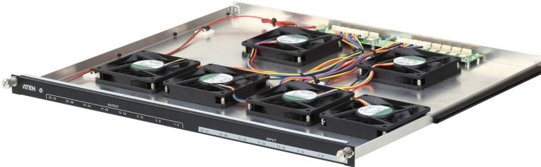
Sobreaquecimento torna o desempenho do dispositivo significativamente mais lento e pode resultar em avarias a meio de operações. O [VM3200](#) está equipado com um módulo de ventoinha que garante que está instalado um sistema de arrefecimento que impede o dispositivo de sobreaquecer. A ventoinha é de ligação directa e pode ser facilmente substituída sem ter de encerrar o sistema. ATEN garante que o seu investimento está protegido, ao mesmo tempo que proporciona um desempenho notável.
