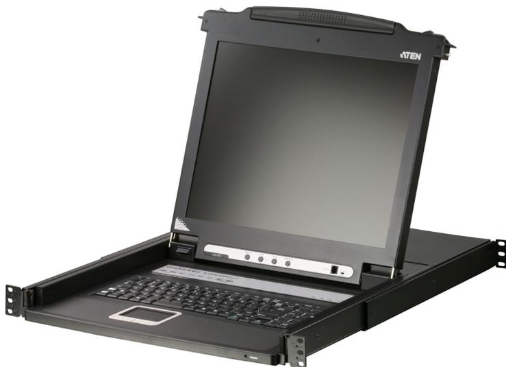
As Gavetas LCD CL1008 KVM Switch são unidades de controle que permitem acesso a vários computadores de um único console com teclado, monitor e mouse (KVM). Uma única CL1008 podem controlar até 8 computadores. Além disso, 15 switches KVM adicionais podem estar em daisy-chained com o CL1008 então, até 256 computadores podem ser controlados de um único console.
