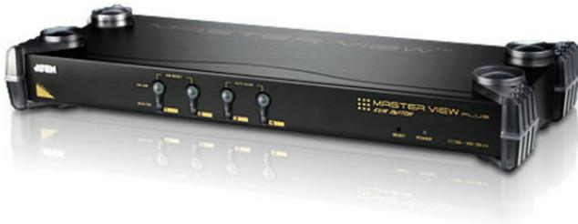
O CS9134 é um Switch KVM com PS/2 embutido. Ele pode controlar 4 servidores através de um único console e permite que usuários alternem entre computadores através de botões no painel frontal do switch e configuração de teclas de atalho no teclado do console. É a solução mais simples e mais conveniente para o gerenciamento de multi computadores. Além disso, suporta conexão de 3 níveis através de cascata. Com 21 conjuntos de CS9134, usuários podem controlar 64 computadores.
