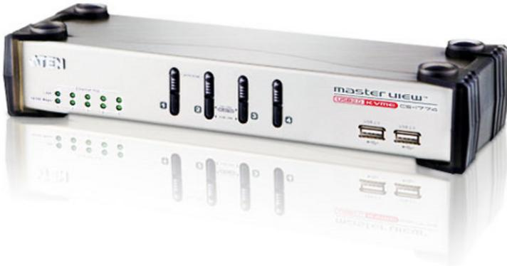
O CS1774 é um KVM switch multi computador com função 3 em 1 (KVM Switch, USB e Ethernet) embutida. Ele pode controlar simultaneamente 4 servidores através de um conjunto de teclado USB, mouse e monitor. Além disso, as portas USB e Ethernet Switch embutidas podem acessar rapidamente dispositivos periféricos USB e compartilhar recursos de internet à vontade.
