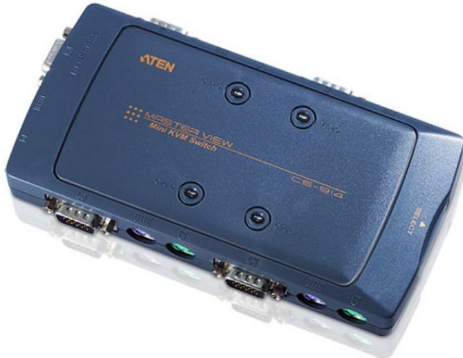
O CS914 é um KVM Switch com PS/2 embutido. Pode controlar 4 servidores através de um único console e permite que usuários alternem entre computadores através de botões na parte superior do switch e configuração de teclas de atalho no teclado do console. É a solução mais simples e conveniente para gerenciamento de vários computadores.
