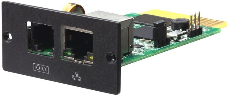
ATEN SP100 (placa SNMP) é um equipamento de monitorização UPS. Permite a ligação da UPS diretamente à rede ethernet através de uma ligação RJ-45 sem usar as portas RS-232 no computador, e sem carregar qualquer software de gestão UPS individual no servidor de rede. O utilizador pode controlar e monitorizar remotamente a UPS e o estado da corrente a partir de qualquer local. SP100 pode comunicar o estado de uma UPS e para ela emitir comandos.
