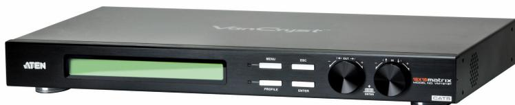
A Solução de Matriz Multimídia VanCryst™ é uma combinação do Switch de Matriz A/V VM1616T 16 x 16 Cat 5 e da Extensão A/V Sobre Cat 5 [VE500/VE300](#). O VM1616T é um Switch de Matriz que utiliza extensores [VE500/VE300](#) para rotear e distribuir sinais áudio, vídeo e RS-232 a distâncias de até 300 metros com resoluções vídeo de 1920 x 1200.
