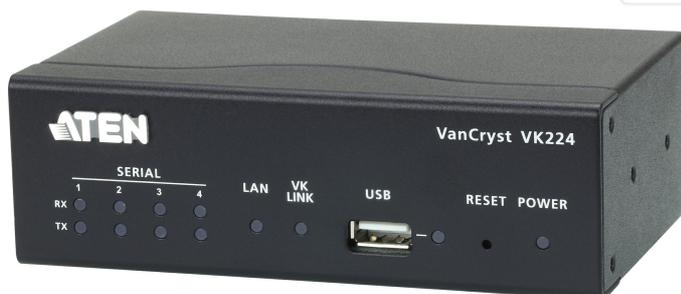
O VK224 fornece conectividade Ethernet-para-série com 4 portas seriais bidirecionais RS-232 / 422 / 485. Permite aos utilizadores aceder remotamente a dispositivos de série a partir de um PC ou de qualquer sistema localizado em qualquer lugar. Os comandos Telnet CLI completos estão totalmente integrados nas aplicações comerciais e industriais dos utilizadores.
