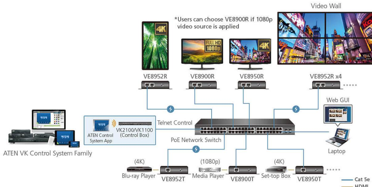
\*Nota: VE8952 suporta PoE e pode ser instalado em conjunto com switches de rede PoE para reduzir cabos de alimentação e tomadas adicionais. Antes de escolher o switch de Rede e instalação, consulte o Guia de Implementação.
