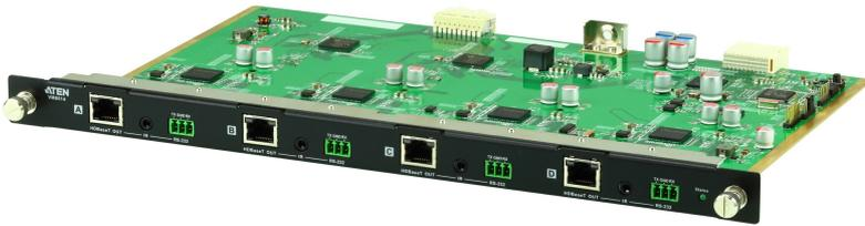
A placa de saída de 4 portas VM8514 HDBaseT proporciona uma forma fácil de rotear 4 transmissores HDBaseT ligados a 4 recetores HDBaseT, e em conjunto com um switches de matriz modular ATEN, a capacidade de rotear até 32 ligações de entrada e 32 ligações de saída HDBaseT.
