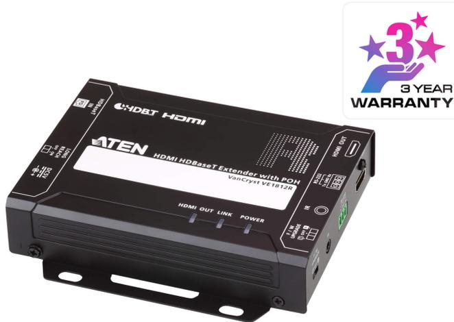
A [VE1812T](#) possui Power over HDBaseT (PoH) o que envia energia de Tx para Rx por cabo Cat 5e/6/6a sem necessidade de fonte de alimentação adicional. A [VE1812T](#) suporta a passagem de sinais RS-232 e IR, permitindo-lhe controlar o dispositivo HDMI fonte a partir da unidade recetora (VE1812R) enquanto acede ao dispositivo de imagem HDMI a partir da unidade transmissora ([VE1812T](#)). Os sinais IR podem também ser prolongados em ambas direções.
