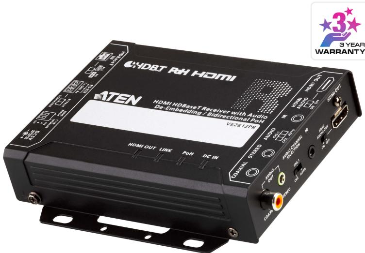
Com a poderosa tecnologia HDBaseT Class A, o VE2812PR é um receptor para vídeo 4K HDMI, áudio e sinais de controlo a uma distância de até 100 m através de um cabo Cat 5e / 6 / 6a ou ATEN [2L-29330](#) Cat 6. A transmissão do sinal HDMI estende-se até 150 m a 1080p quando o modo de longo alcance HDBaseT está ativado.
