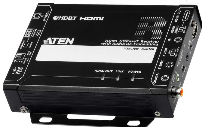
VE2812R é um Recetor HDMI HDBaseT de alta qualidade com função de separação áudio. Graças à tecnologia HDBaseT™, VE2812R pode receber sinais 4K HDMI até 100 m através de um só cabo Cat 5e/6/6a ou ATEN [2L-2910](#) Cat 6. Com o Modo HDBaseT Longo Alcance ativado, pode fazer chegar sinais HDMI até um máximo de 150 metros @ 1080p.
