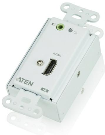
O Transmissor HDMI através de Cat 5 para Montagem na Parede VE806T permite ligar a um [VE806R](#) para aumentar o alcance dos sinais até 60 m a partir da fonte utilizando cabos Cat 5e. Suporta formatos comuns de vídeo panorâmico e garante uma excelente qualidade de vídeo em transmissões de longa distância. A combinação de outros [VE806](#) permite aumentar ainda mais a distância ou multiplicar as fontes/monitores.
